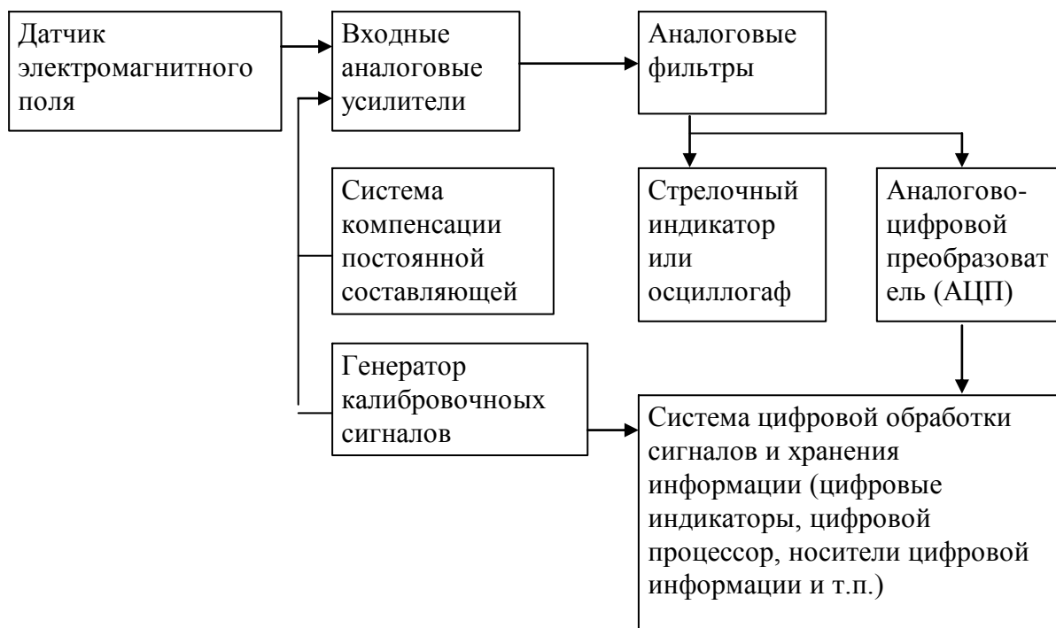
Рис. 2. Общая блок-схема измерительных электроразведочных устройств.
